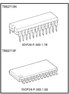
Weight SDIP24-P-300-1.78: 1.62 g (typ.) SSOP24-P-300-1.00: 0.32 g (typ.)
